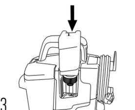
3 Remettez le capuchon et serrez-le. Faites glisser le réservoir pour le remettre en place dans l'appareil.
