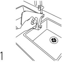
1 Videz le réservoir d'eau sale. Appuyez sur le bouton de dégagement du réservoir, puis soulevez le couvercle pour le vider et le rincer. L'eau propre permettra d'enlever la saleté et les débris du réservoir. Laissez le réservoir sécher à l'air libre avant de le remettre en place.
