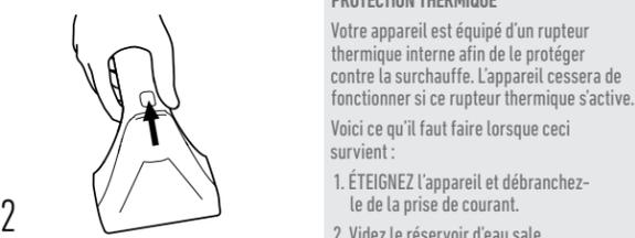
2 Rincez l'accessoire à main sous le robinet. Enlevez le couvercle de la buse en appuyant sur le bouton de dégagement situé sur le dessus.
