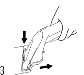
Pour éliminer la tache, aspirez la saleté et la solution de nettoyage en appliquant une pression vers le bas à l'avant de l'accessoire de nettoyage tout en le tirant vers vous. Répétez l'opération si nécessaire.
