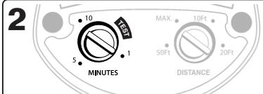
La commande **MINUTES** détermine la durée pendant laquelle les lumières restent allumées. Lorsque la commande **MINUTES** est réglée entre 1 et 10, la lumière ne s'allume que pendant les heures de la nuit.
